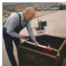
Enderezamiento de una caja metálica mediante un cilindro hidráulico YS-10/150, un tubo de extensión AYS-106, una base adaptadora AYS-103 y una bomba eléctrica PY-04/2/5/2 M.
