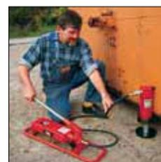
Elevación de un contenedor mediante un cilindro hidráulico YS-23/160, una uña de elevación AYS-23 y una base de pistón AYS-232 alimentados por una bomba manual de dos etapas HPS-2/2 con base de apoyo.
